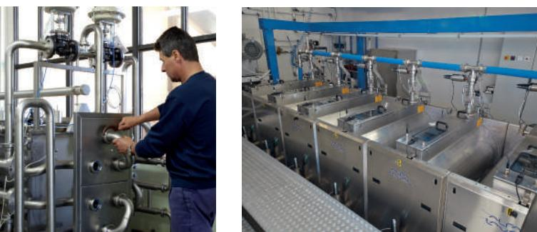
Εναλλάκτες ταχείας θέρμανσης Express Heaters, για χαμηλής θερμοκρασίας έκθλιψη (αριστερά), και κυλινδρικοί μαλακτήρες Atmosphera οικονομίας ρεύματος (δεξιά)
