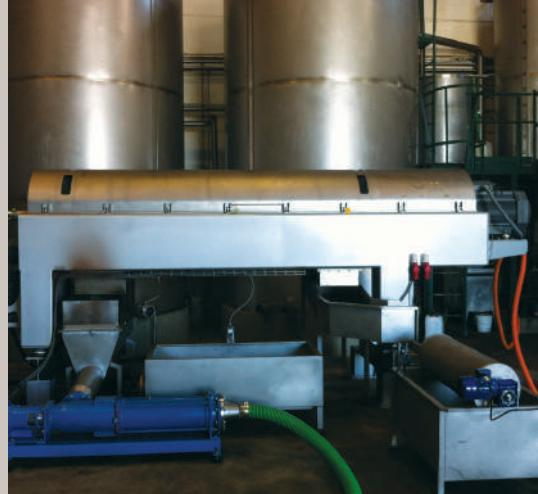
Δεύτερη έκθλιψη (repasso) με βέλτιστη ανάκτηση λαδιού και ελαχιστοποιημένη περιβαλλοντική επίπτωση
